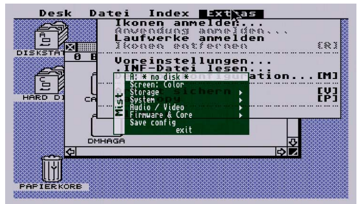
MiST kann sich auch in einen Atari ST verwandeln, hier mit überlagertem On-Screen-Menü.
