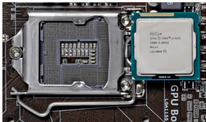
umschaltung im laufenden Betrieb, die einerseits fürs Energiesparen im Leerlauf und andererseits für die Turbo-Funktion wichtig ist, bleibt dabei funktionsfähig. Intels K-Typen fehlen Spezialitäten wie die PCI-Express-Virtualisierung VT-d. Zum Übertakten braucht man außerdem ein Mainboard mit dem Chipsatz Z77 oder Z75; beim H77 kann man nur jene Multiplikatorstufen wählen, die auch der Turbo-Modus verwendet – also typischerweise viermal 100 MHz mehr als die Nennfrequenz.
