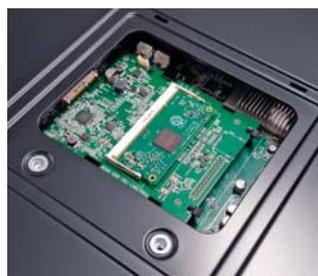
Das Mainboard, auf dem das Raspi 3 Compute Module sitzt, lässt sich aus dem Monitor herausnehmen und der GPIO-Anschluss bei Bedarf mit einem Pfostenstecker bestücken.
