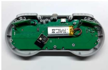
Der kleine Akku hat eine Kapazität von lediglich 180 mAh und hält maximal sieben Stunden durch.
