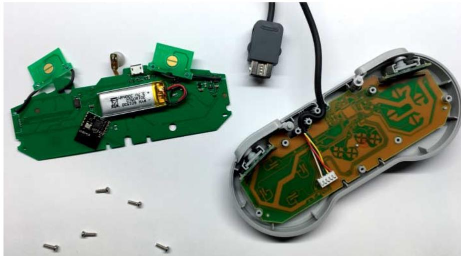
Der Umbau erfordert kaum handwerkliches Geschick. Im Grunde muss man den Controller nur aufschrauben und die alte Platine (rechts) mit der neuen (links) tauschen.
