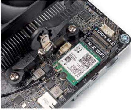
Intels Wi-Fi-6-WLAN-Karte AX200 läuft problemlos im Asrock-Barebone Deskmini A300 für Kompakt-PCs. Das 12-Euro-Kärtchen steigerte im c't-Versuch den WLAN-Durchsatz um 60 bis 130 Prozent gegenüber dem Original.
