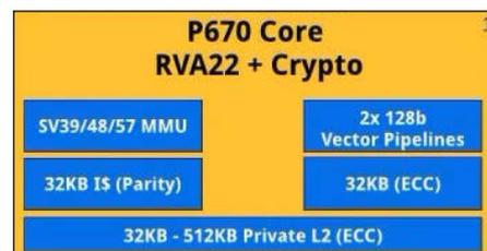
**Der RISC-V-Rechenkern SiFive Performance P670 soll mit einem ARM Cortex-A78 mithalten. In einem System-on-Chip (SoC) rechnen bis zu 16 P670 gemeinsam.**
